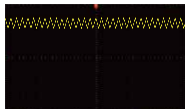
DC+AC Vdc=50V, 三角波形紋波 Vac=5V, 頻率 1000Hz
