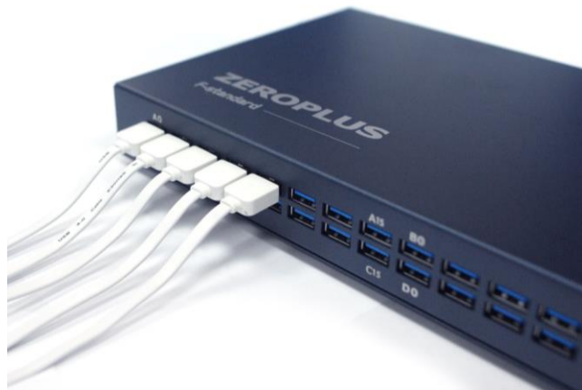
圖2.4 測試線連接至 LAP-F1
