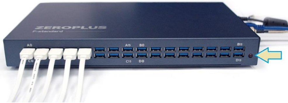
圖2.5 連接電源線和信號線
